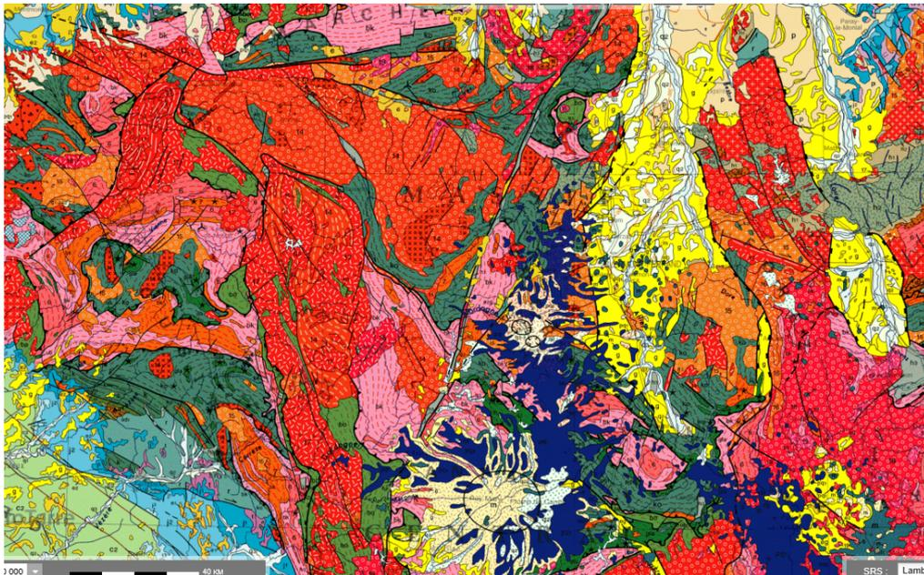
2°) Le **Sillon-Houiller**, grand accident recoupant tout l'Ouest du Massif central suivant une direction NNE-SSO, est particulièrement développé dans cette région du Cantal : secteurs d'Ydes et de Bassignac, où l'exploitation du charbon fut importante de 1850 à 1950 environ. La formation de ce sillon implique au moins les 3 étapes suivantes, qui ont eu lieu vers la fin de l'orogénèse hercynienne :
