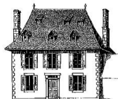
5 - Carladez. Maison de maître. Deux rangées de lucarnes. Hautes cheminées sur un toit à quatre pentes. Porte avec pilastres (Carlat, Vic-sur-Cère).
